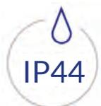
les panneaux chauffant infrarouge se distinguent par le degré de protection au niveau **IP44**. Ceci signifie qu'il est possible de les installer dans les salles de bains. En outre, ils sont munis d'un verrouillage contre les personnes non autorisées, une excellente protection pour les familles avec de petits enfants.
